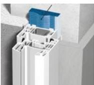
Para el **sellado interior** se puede utilizar sellantes interiores, cintas auto expansivas, membranas de estanquidad o membranas líquidas.
